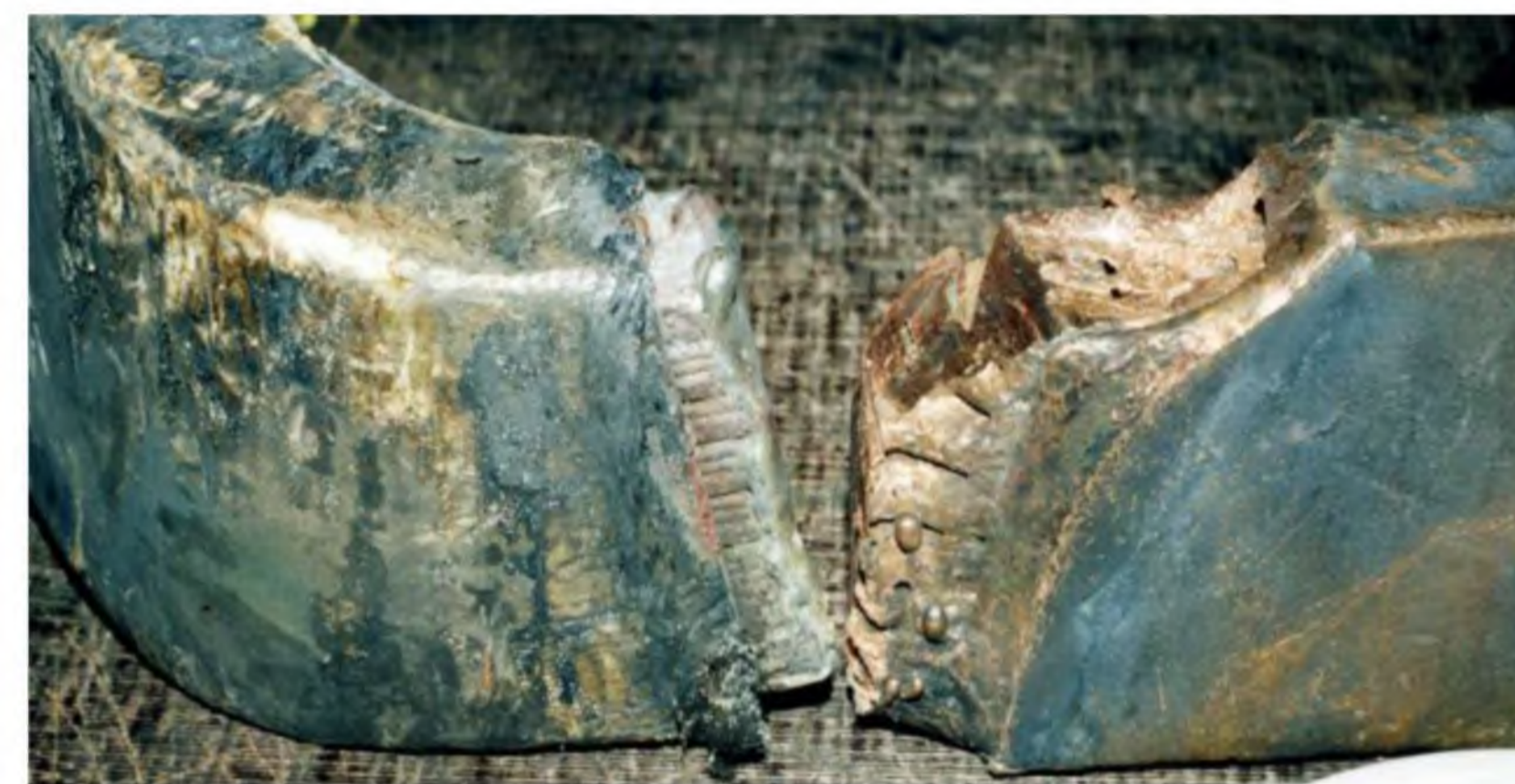
Усталостный излом и расплавление проводников и наконечника выводного стержня
