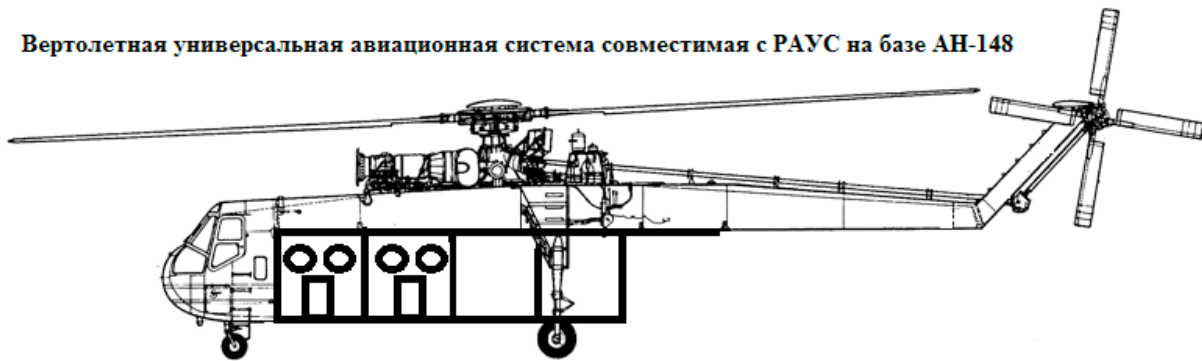
Рис. 14. Совместимость модуль-контейнера с вертолетом
