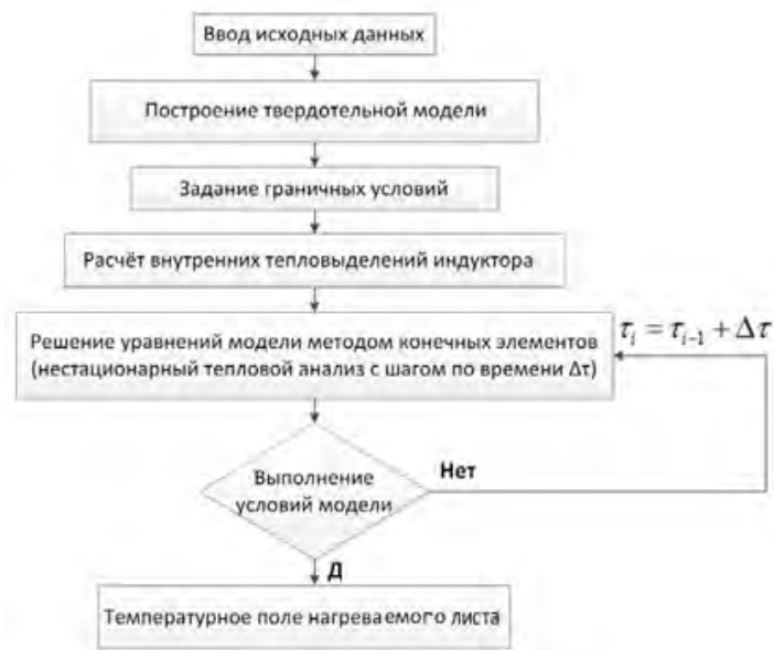
Рис. 4. Алгоритм решения модели с помощью МКЭ [15]
