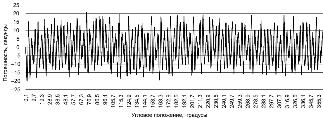
Рис. 7. Разница показаний эталонного датчика и преобразователя угол-код
