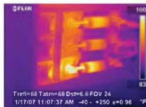
Тепловое изображение ослабленного соединения
