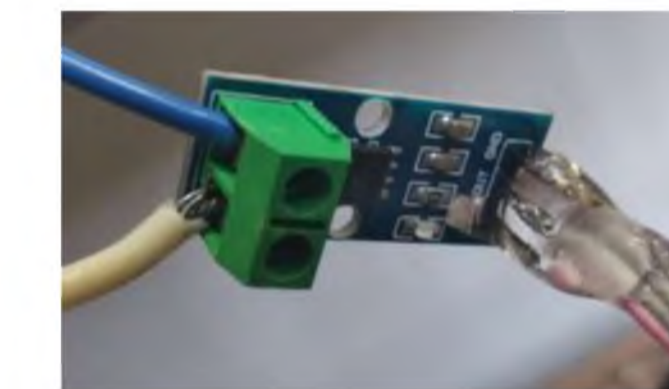
Внешний вид и схема подключения датчика ACS712
