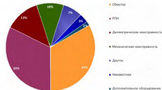
Статистика неисправности элементов силового трансформатора
