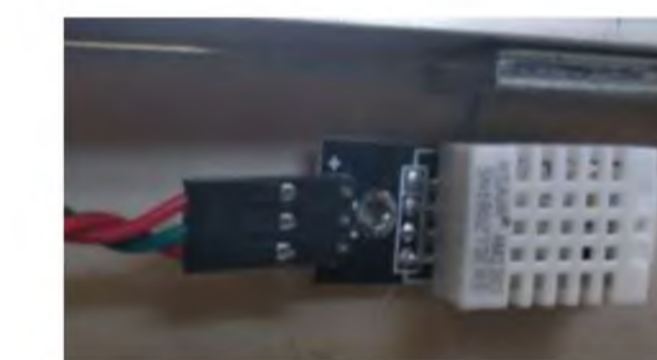
Внешний вид и схема подключения цифрового датчика температуры и влажности высокой точности DHT22
