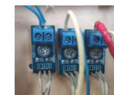
Внешний вид и схема подключения модуля Voltage Sensor
