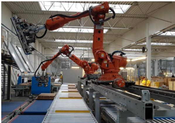
*Рис. 5. Пример мехатронного устройства линейного перемещения в логистике*
