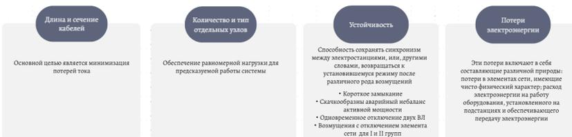
Рис. 3. Факторы, учитываемые при проектировании электрической системы
