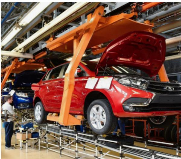
*Рис. 6. На ВАЗ заготовки доставляются на следующий этап по платформам линейного перемещения*
