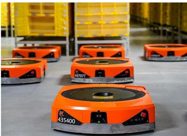
Рис. 5. Автономный складской робот Amazon Hercules
