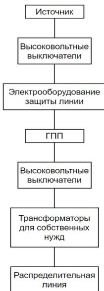
Рис. 1. Внешняя блок-схема электроснабжения с одним источником питания
