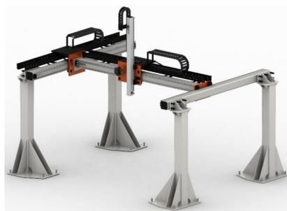
*Рис. 2. Пример перемещения моста и тележки портального промышленного робота по мехатронным модулям линейного перемещения*
