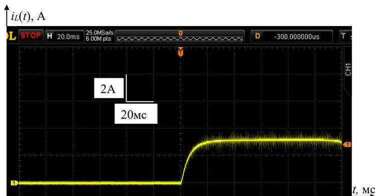
Рис. 5. Осциллограмма переходного процесса тока дросселя
