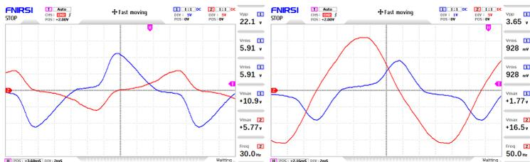
Рис. 2. Осциллограммы холостого хода: Синий (1) – ток 1 А/дел, Красный (2) – напряжение 5 В/дел; а)  $w_1 = 84, w_2 = 42$ ; б)  $w_1 = 42, w_2 = 84$
