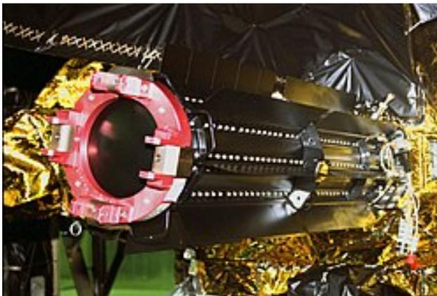
Рис. 3. РИТЭГ космического зонда «Кассини» [3]
