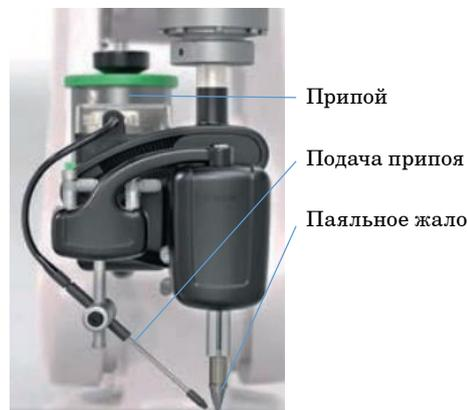
• *Рис. 2. Паяльный модуль (рабочий инструмент)*
