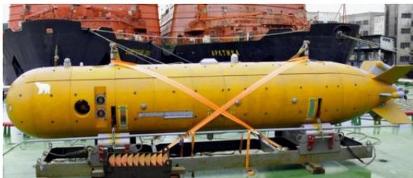
2. Подводный робот «Клавесин» (КБ «Рубин») предназначен для исследования морского дна и зондирования грунта, способен проводить научные исследования на глубине до 6 тыс. метров. Аппарат может быть установлен на любом военно-морском корабле. В настоящее время он успешно эксплуатируется на Тихоокеанском флоте.
