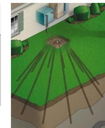
Рисунок 8. Веерное расположение скважин
