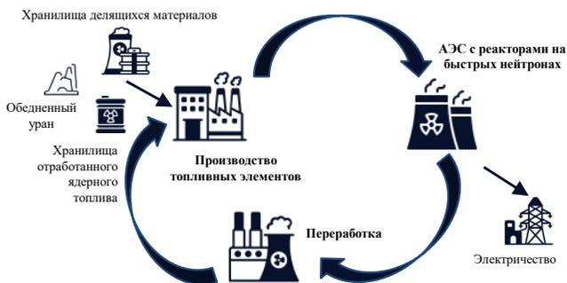
Реакторы на быстрых нейтронах позволяют осуществить расширенное воспроизводство ядерного топлива за счет конверсии урана-238 в плутоний-239.
