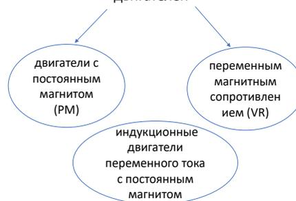
Лучший пример такого объединения продемонстрировала компания QM Power. Два магнитных потока протекают по одному и тем же магнитным элементам электродвигателя: один поток формируется двумя PM, а другой — VR-обмоткой ротора-статора.
