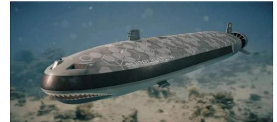
5. Беспилотный аппарат «Сарма» - совместная разработка ЦКБ «Лазурит» и концерна «Алмаз-Антей». Он предназначен для обеспечения безопасности прохода судов по Северному морскому пути. Данный аппарат оснащен высокоточным навигационным оборудованием, которое позволяет осуществлять ориентирование с помощью рельефа дна и инерции, что обеспечивает полную скрытность. «Сарма» способен проплывать не менее 10 000 километров под водой, а автономность глубоководного плавания составляет 3 месяца.
