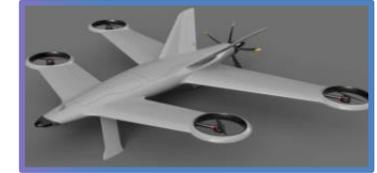
**Гибридные беспилотные летательные аппараты (БПЛА)** представляют собой дроны, способные выполнять множество разнообразных задач благодаря комбинации различных технических возможностей. Они могут объединять в себе преимущества вертикального взлета и посадки, характерных для мультикоптеров, с возможностью длительных автономных полетов и эффективного патрулирования территории, характерной для беспилотных аппаратов с фиксированным крылом.
