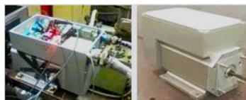
Рисунок 2 – Электропривод насоса ЭП-25
