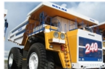
Комплектный электропривод КТЭ-240 для автосамосвала 7531 г/п 240 тонн
