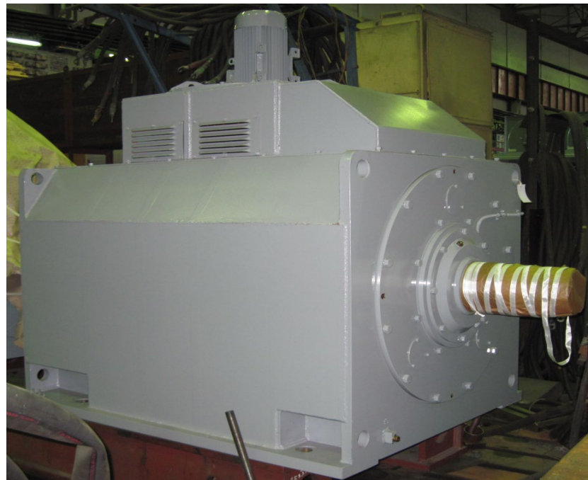
Электродвигатель АДРЭ-С 1120-8 УХЛ2 привода подъема шагающего экскаватора ЭШ24.95
