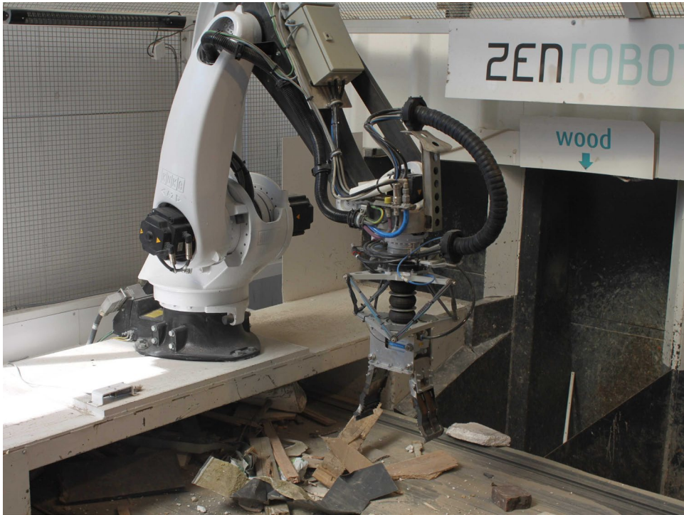
Пример сортировки с промышленным роботом
