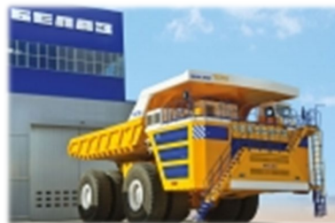
Комплектный электропривод КТЭ-450 для автосамосвала 7571 г/п 450 тонн. Стадия проектирования.
