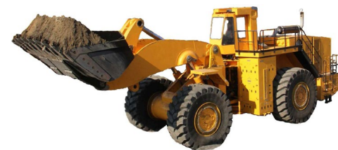
Комплектный электропривод для погрузчика с объемом ковша 11,5 куб.м. На стадии испытаний.
