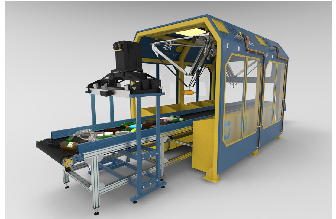
Пример сортировки с дельта роботом
