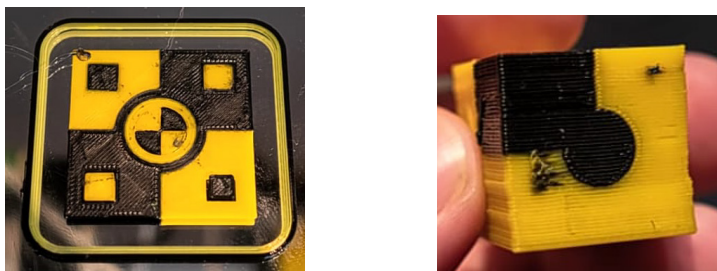
Рис. 2. Брак в работе экструдера 3D-принтера
