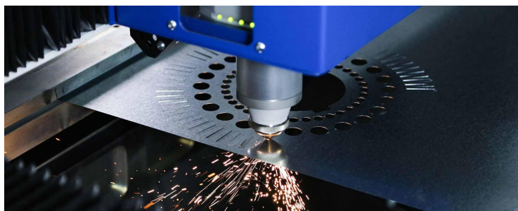
Рис. 7. Процесс лазерной резки по металлу
