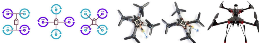
Рис. 3. Внешний вид квадрокоптера и схема возможного расположения винтов
