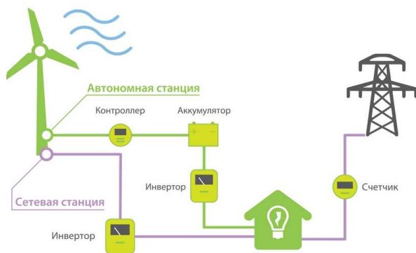
Рис. 1. Набор оборудования в ВЭУ
