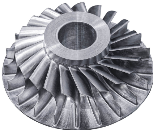
Рис. 8. Деталь турбины самолета, созданная методом аддитивных технологий
