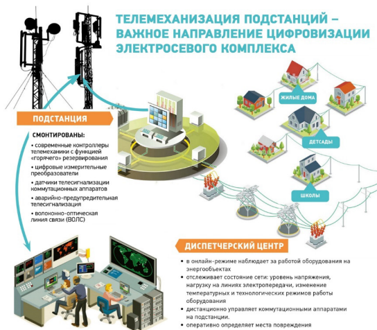
Рис. 3. Преимущества цифровизации трансформаторных подстанций
