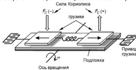
Рис. 6. Устройство интегрального гироскопа
