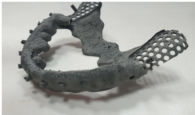
Рис. 6. Имплантат, созданный методом лазерного спекания порошков
