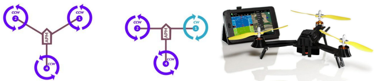
Рис. 2. Внешний вид трикоптера и схема возможного расположения винтов
