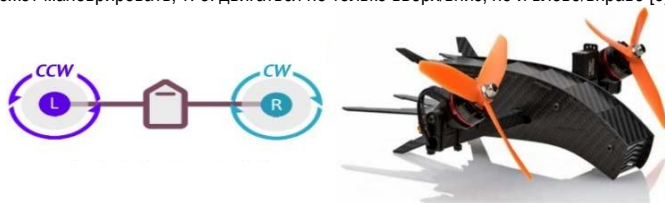
Рис. 1. Внешний вид бикоптера и схема расположения винтов (пропеллеров)
