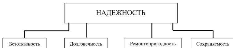
Рис. 1. Основные аспекты надежности системы электроснабжения
