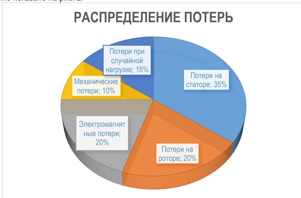
Рис. 2. Распределение потерь асинхронного двигателя
