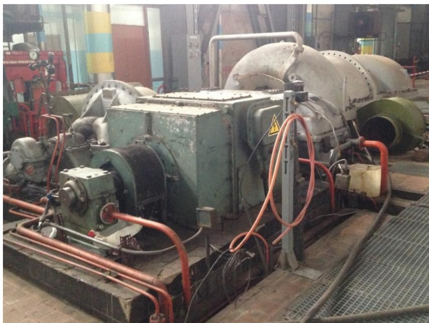
Рис. 2. Асинхронный двигатель с фазным ротором, установленный на ГТТ-ЗМ
