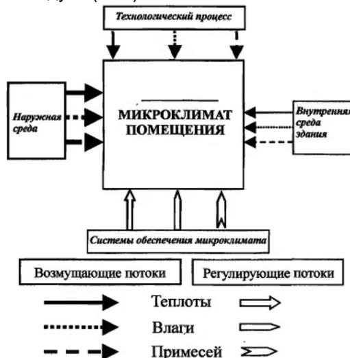
Рис. 1. Структурная схема формирования микроклимата [1]
