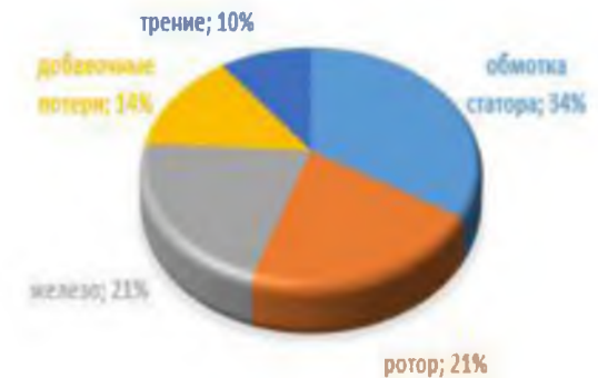
РАСПРЕДЕЛЕНИЕ ПОТЕРЬ МОЩНОСТИ ПРИ РАБОТЕ АСИНХРОННОГО ДВИГАТЕЛЯ:
