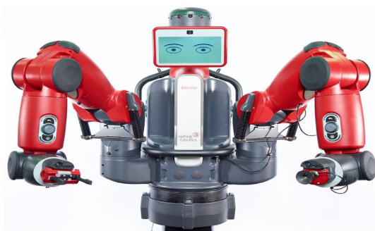
Рис. 6. Бакстер – робот, собранный лишь с использованием электроприводов
