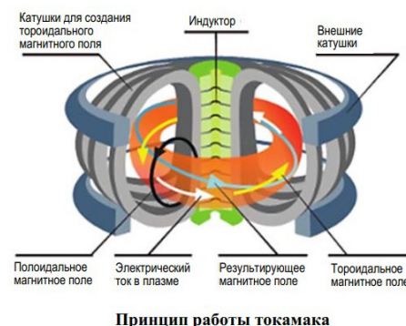
Рис. 6. Принцип работы токамака
