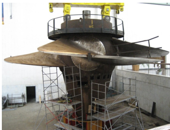
Рис. 2. Рабочее колесо поворотно-лопастной турбины
