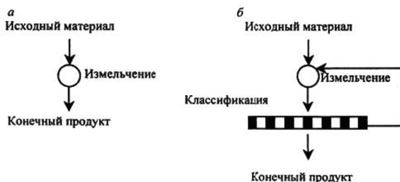
Рис. 1. Циклы измельчения: а – открытый; б – замкнутый [1]
