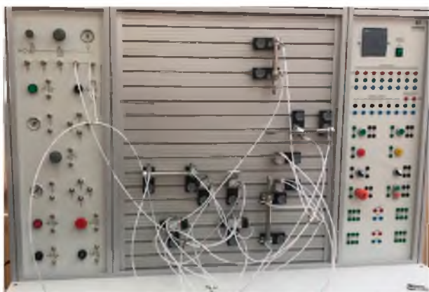
Рис. 3. Реализация системы подачи заготовок на стенде
