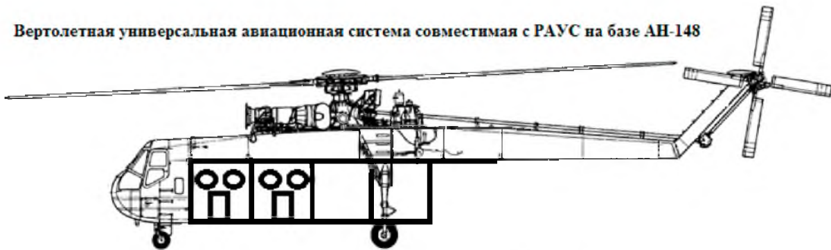
Рис. 14. Совместимость модуль-контейнера с вертолетом
