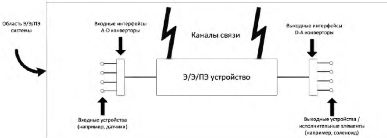
Рис. 2. Структура Э/Э/ПЭ системы
