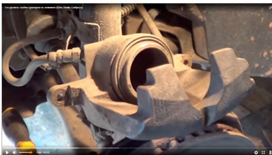
Рис. 1. На переднем плане размещен суппорт типа «TEVES» с силовым поршнем, передающим давление на тормозной диск автомобиля
