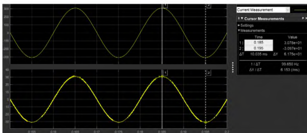
Рис. 2. Фазное напряжение питания и сетевой ток АВН в номинальном режиме работы (РСАР)
