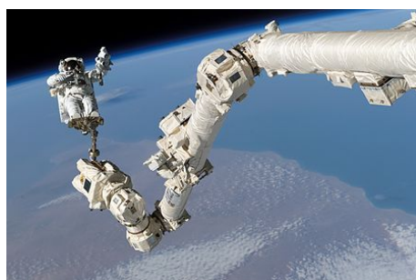
Рис. 2: а – внешний вид манипулятора «Canadarm-1»; б – астронавт Стивен Робинсон, удерживаемый системой «Canadarm-2»
