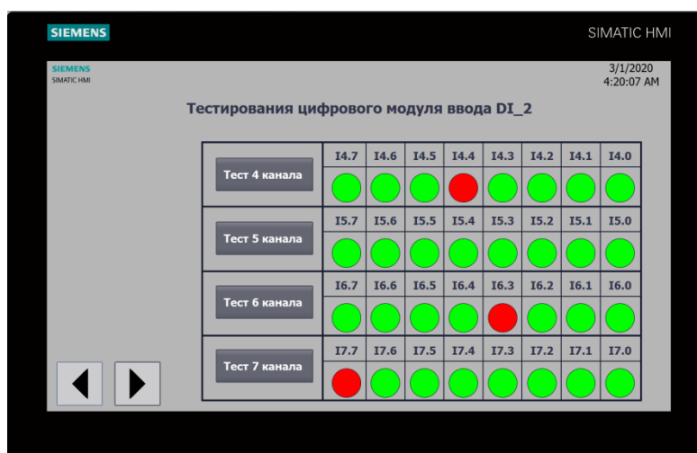
Рис. 13. Экран тестирования второго модуля цифровых входов DI_2
