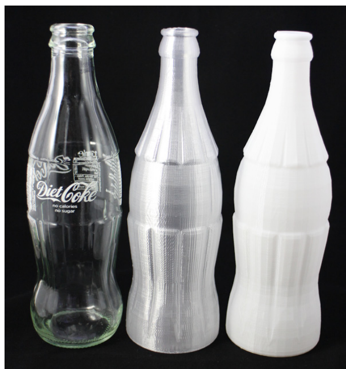
Рис. 10. Внешний вид напечатанного изделия из полиэтилентерефталата (ПЭТ) и полилактида (PLA)
