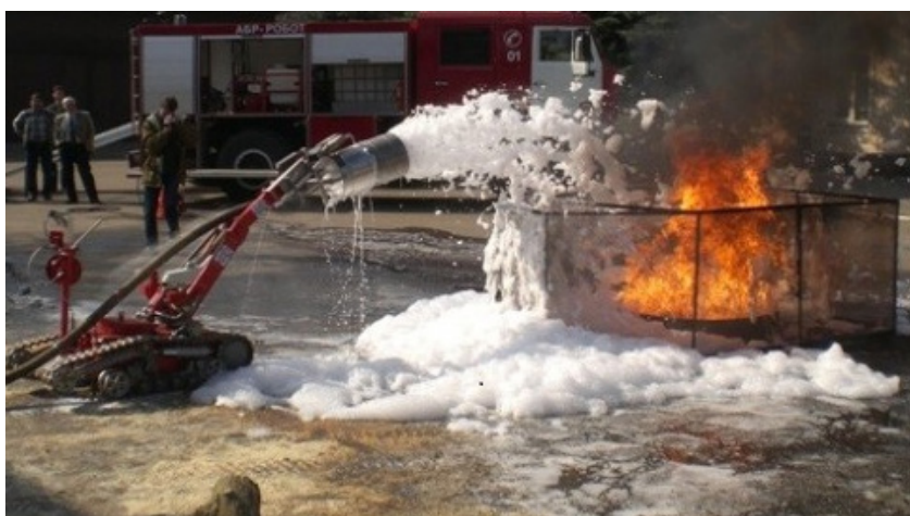
Рис. 5. Испытания робота МРК-РП при тушении пожара пеной
