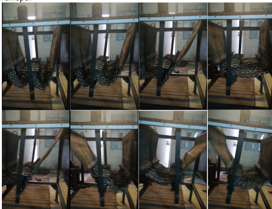
Рис. 3. Кинограмма процесса движения рабочих органов виброударного цепного агрегата (рабочая камера не загружена)
