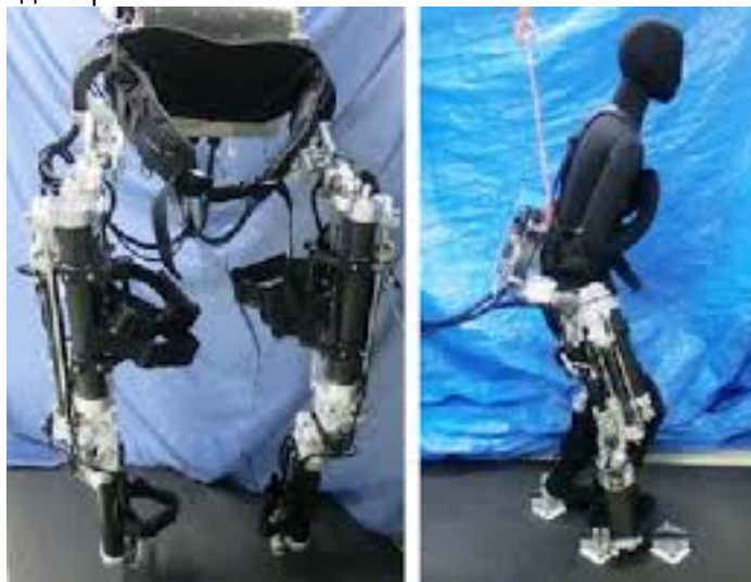
Рис. 5. Гибридный привод ATR eXoskeleton Robot (XoR)
