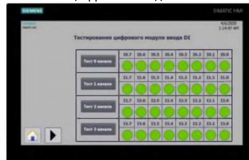
Экран тестирования первого модуля цифровых входов DI
