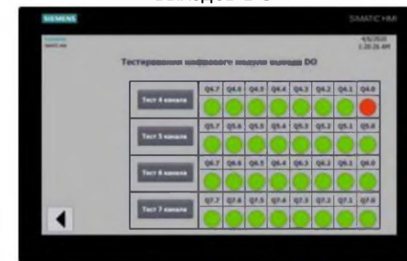
Экран тестирования модуля цифровых выходов DO
