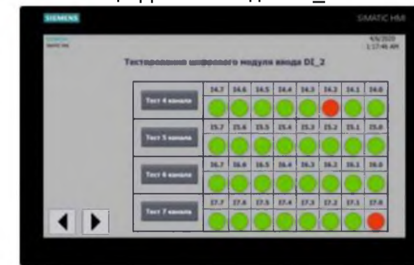
Экран тестирования второго модуля цифровых входов DI_2
