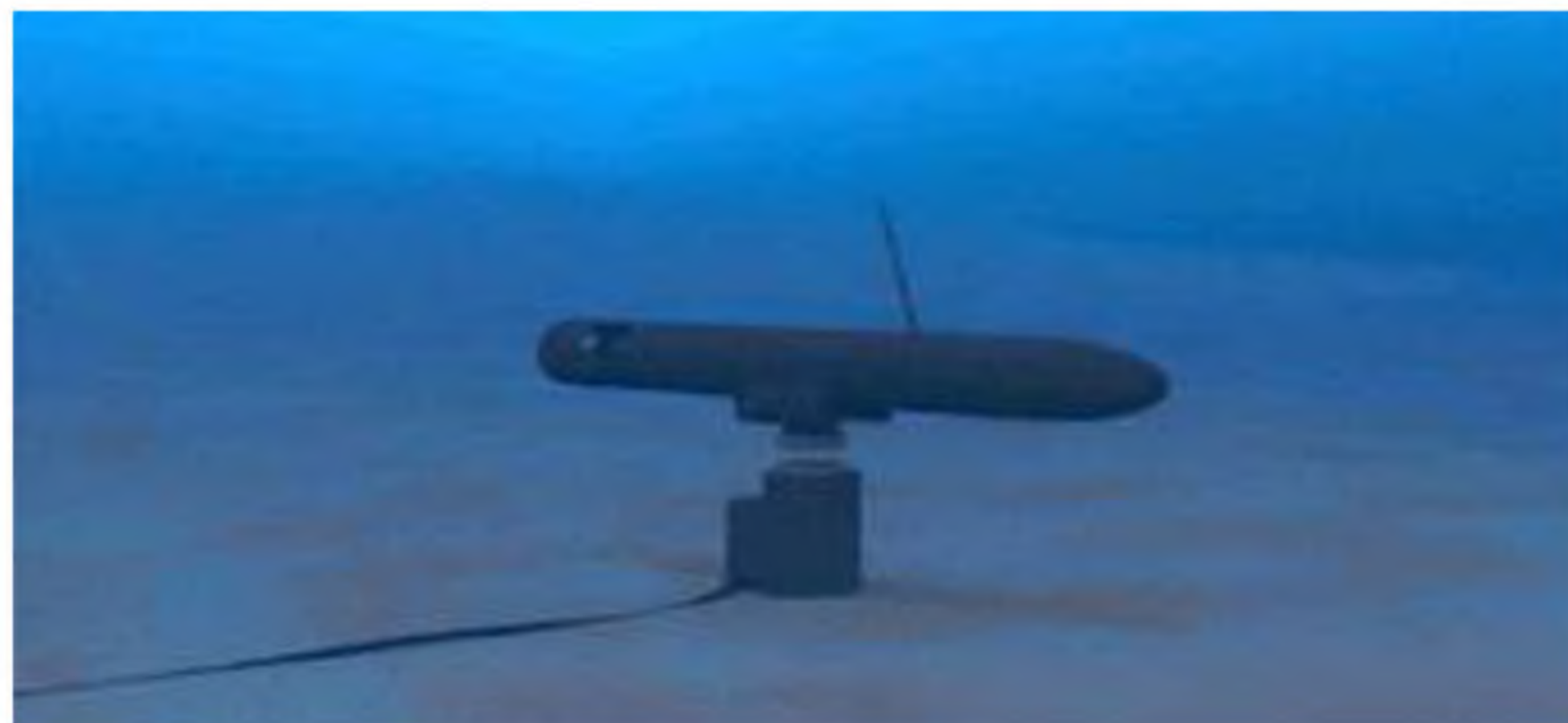
Рис.1 Испытания работоспособности бесконтактного зарядного устройства мощностью до 2.2кВт
