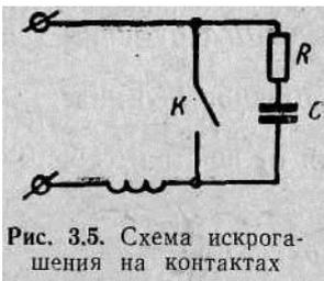
Рис. 3.5. Схема искрогашения на контактах
