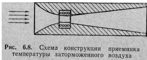
Рис. 6.8. Схема конструкции приемника температуры заторможенного воздуха
