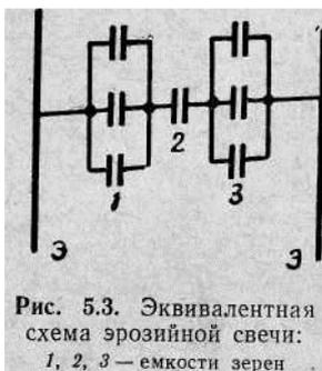
Рис. 5.3. Эквивалентная схема эрозийной свечи:
