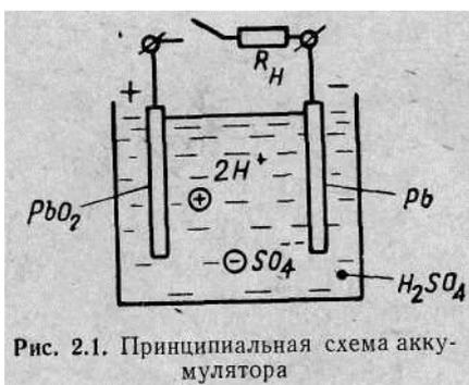
Рис. 2.1. Принципиальная схема аккумулятора
