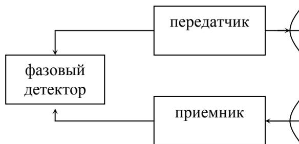
Рис. 10. Функциональная схема фазового дальномера
