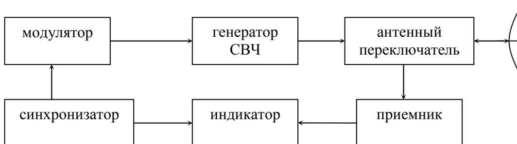
Рис. 6. Функциональная схема импульсного радиолокационного дальномера
