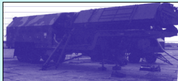
Радиолокационная станция 19Ж6 в транспортном и боевом положениях
