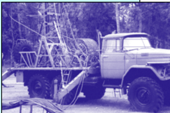
Основание АМУ "Сосна" на базе шасси автомобиля ЗиЛ-131Н
