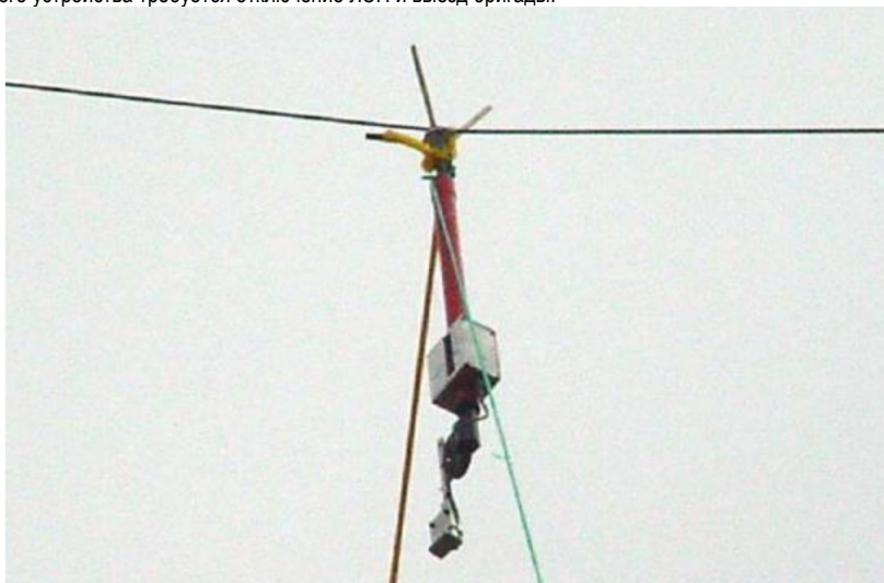
Рис. 4. Устройство DAC, размещенное на проводе ЛЭП
