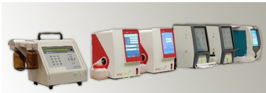
Рис. 1. ИК-анализаторы нефтепродуктов разных торговых марок
