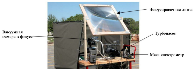
Рис. 3. Прототип установки для термического разложения реголита
