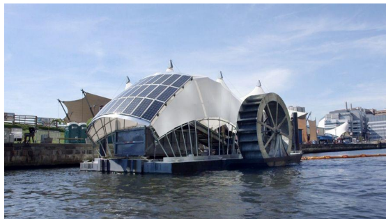
Рис. 3. Водный колесный перехватчик компании «ClearwaterMills»
