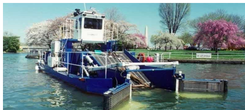
Рис. 4. Мусороперехватчик «Trash Cat United Marine International»
