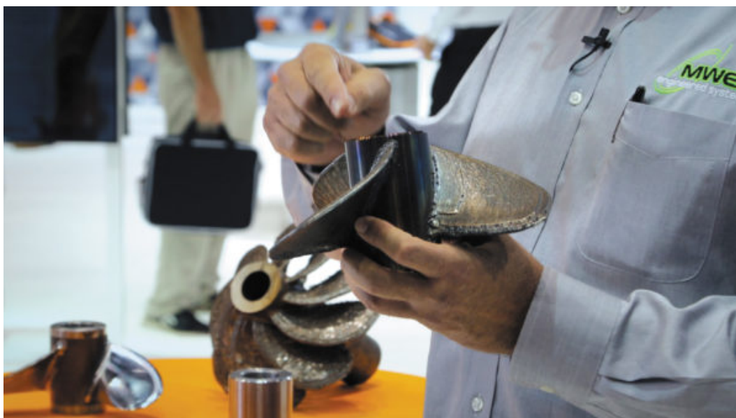
Рис. 2. Заготовка гребного винта, изготовленная с использованием аддитивной лазерной технологии, до ее финишной обработки
