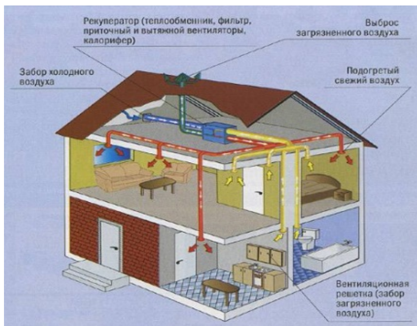
Рис. 2. Пример работы рекуперационной системы
