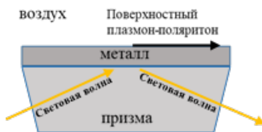
Рис. 1. Распространение поверхностного плазмона в волноводной структуре (конфигурация Кречмана)
