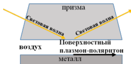
Рис. 2. Распространение поверхностного плазмона в волноводной структуре (конфигурация Отто)
