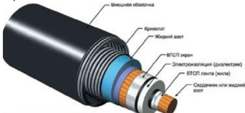
*Рис. 2. Конструкция ВТСП-кабеля с «холодным диэлектриком»*
