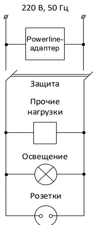
*Рис. 1. Схема подключения интернета по низковольтной электрической сети*
