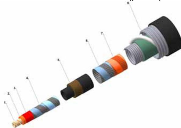
*Рис. 3. Сверхпроводящий силовой кабель:
