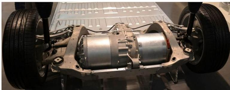
Рис. 3. Расположение тягового электродвигателя
