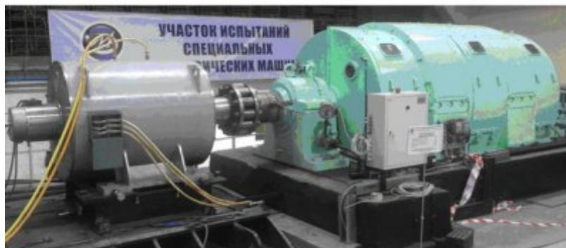
Рис. 2. Первый в мире синхронный ветрогенератор мощностью 1 МВА с обмотками из ВТСП второго поколения
