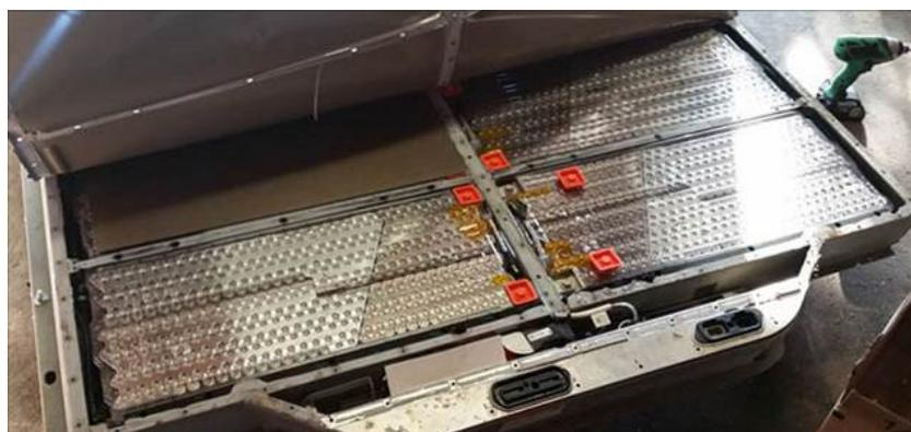
Рис. 2. Вид АКБ электромобиля в разобранном виде
