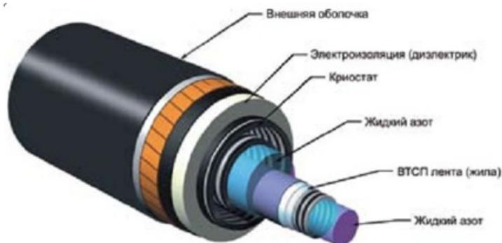
*Рис. 1. Конструкция ВТСП-кабеля с «теплым диэлектриком»*
