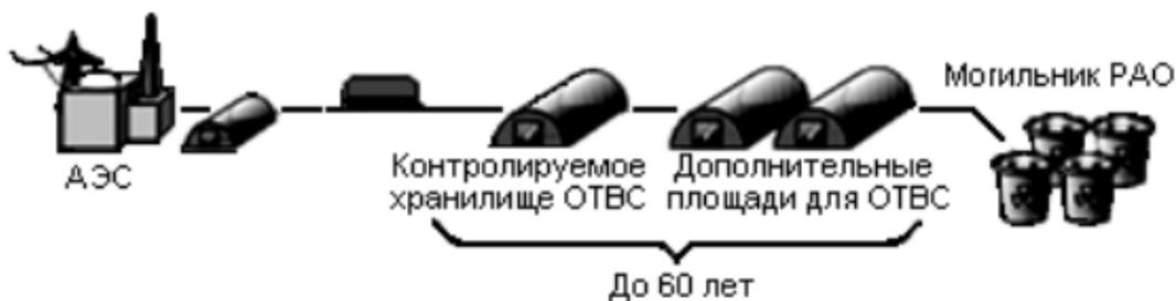
*Рис. 1. Разомкнутый ядерный топливный цикл*
