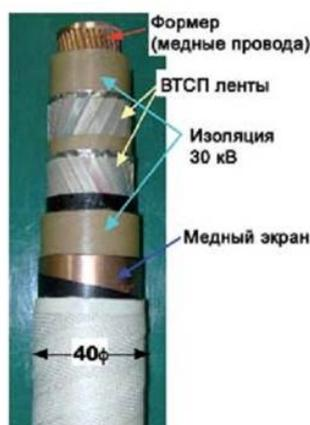
Рис. 4. Конструкция ВТСП-кабеля постоянного тока 20 кВ ChubuUniversity
