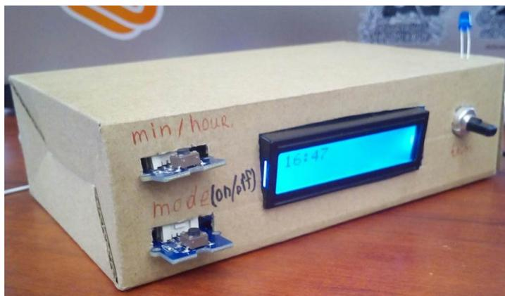
Рис. 2. Собранный на базе Intel Edison прототип
