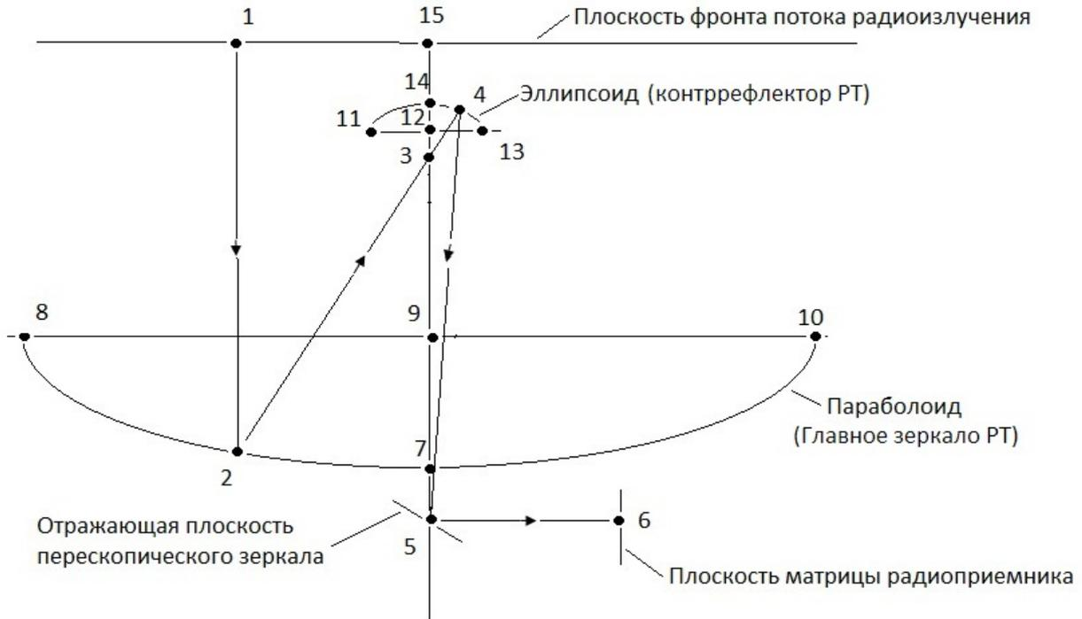
Рис. 1. Ход лучей в 3-зеркальной системе приема радиотелескопа
