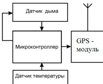
Рис. 1. Структурная схема лесного пожарного извещателя
