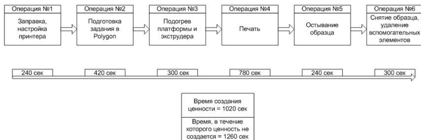
Рис. 2. Карта потока создания ценности FDM-технологии производства
