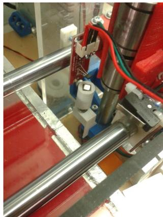
Рис. 5. Вид на датчик. Магнит позволяет отстроить срабатывание датчика на нужной высоте
