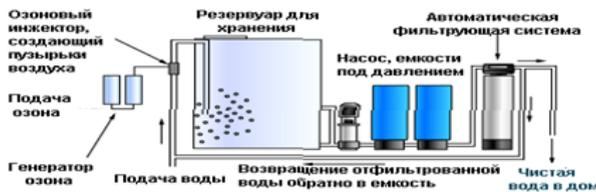
Рис. 1. Пример установки озонowego обеззараживания воды
