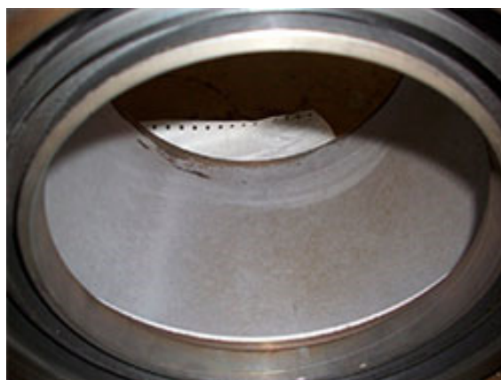
Рис. 4. Вагонная букса после очистки
