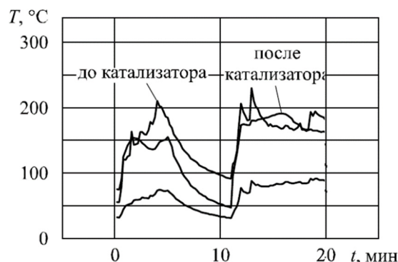
Рис. 1. Изменение температуры выхлопных газов до и после катализатора с течением времени
