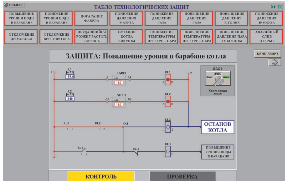
Рис. 6. Экран контроля состояния технологических защит
