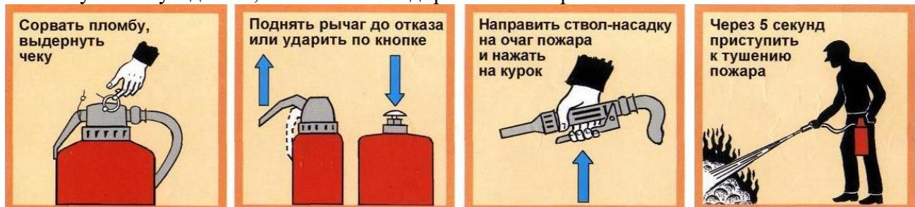
Рис. Приведение в действие огнетушителя с газовым источником давления
