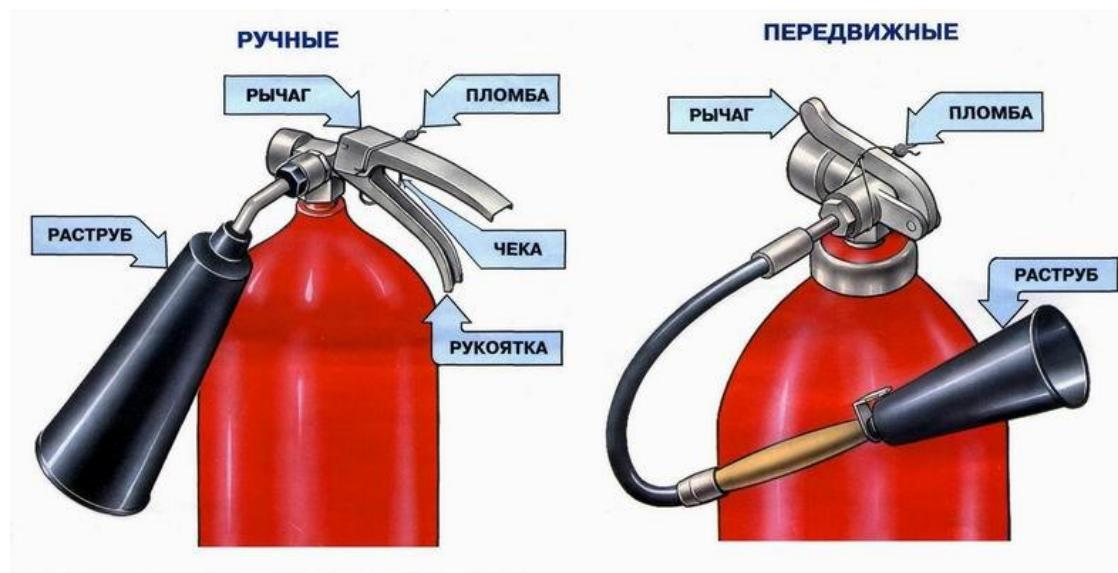
Рис. Внешний вид углекислотных огнетушителей
