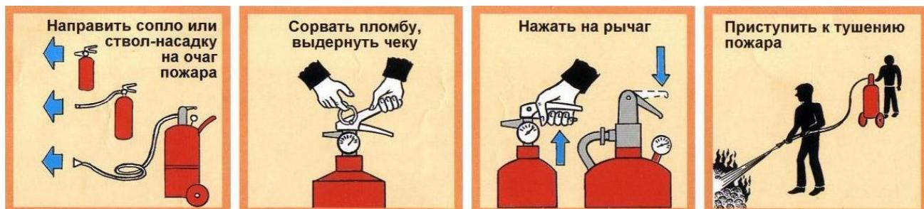
Рис. Приведение в действие закачного огнетушителя
