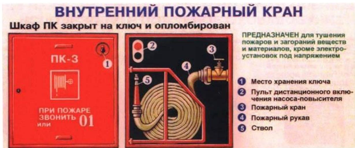
Рис. Внешний вид внутреннего пожарного крана
