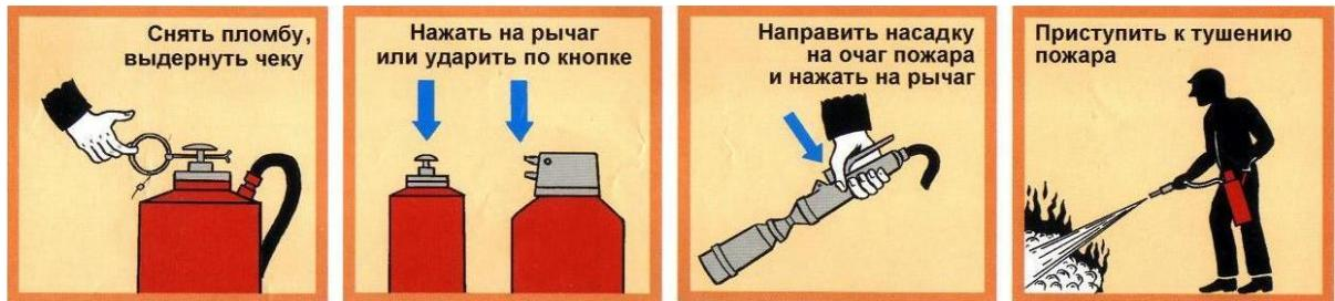
Рис. Приведение в действие воздушно-пенного огнетушителя
