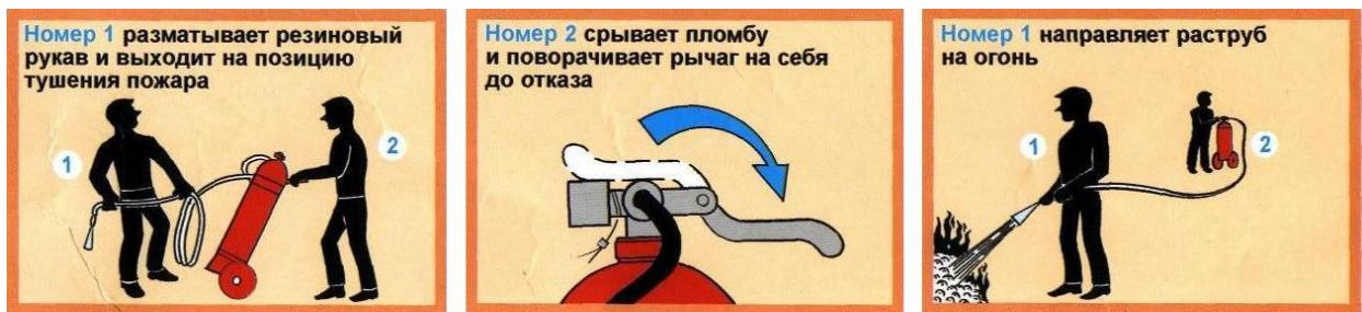
Рис. Приведение в действие передвижного углекислотного огнетушителя
