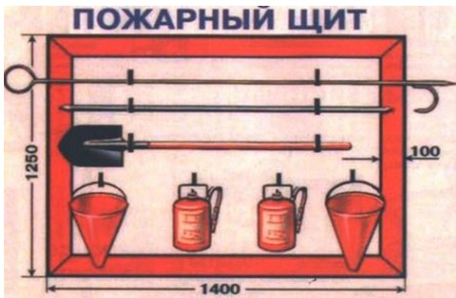
Рис. Внешний вид пожарного щита
