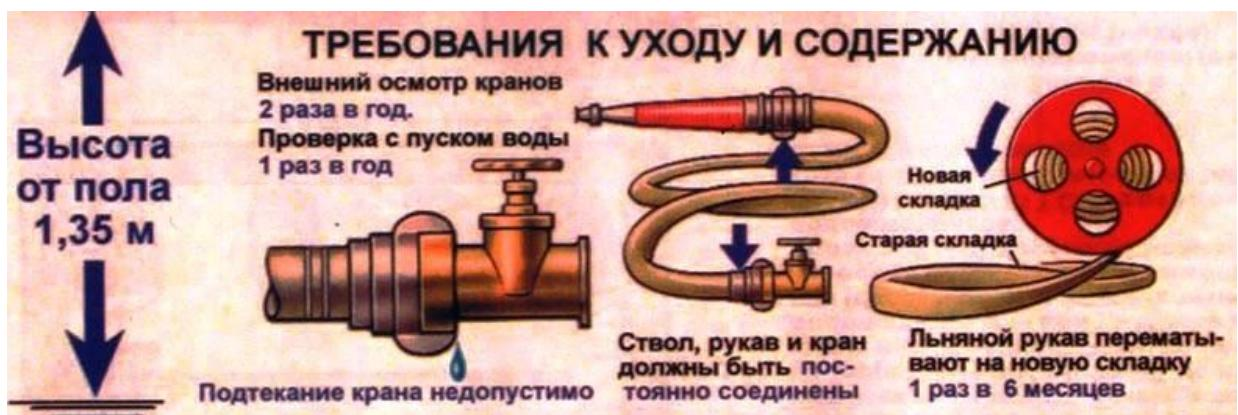
Рис. Требования по уходу и содержанию внутреннего пожарного крана
