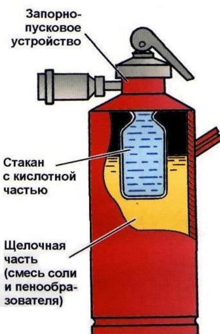
Рис. Внутреннее строение химических пенных огнетушителей
