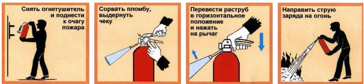
Рис. Приведение в действие ручного углекислотного огнетушителя
