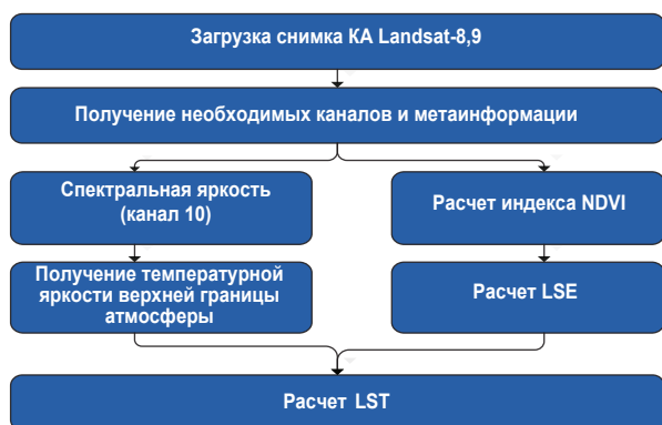
Рис. 1. Схема расчета температуры земной поверхности (LST) по данным KA Landsat-8
