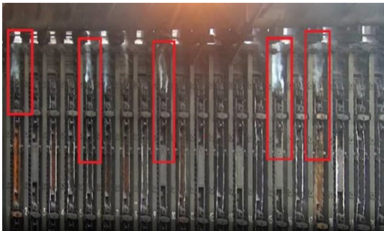
Рис. 2. Определение утечек газа на коксовых батареях [5]
