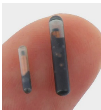
Рис. 1. Размер RFID-меток по сравнению с пальцем человека [6]
