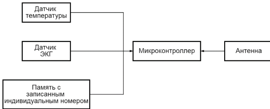
Рис. 4. Схема устройства RFID-метки с датчиками состояния организма
