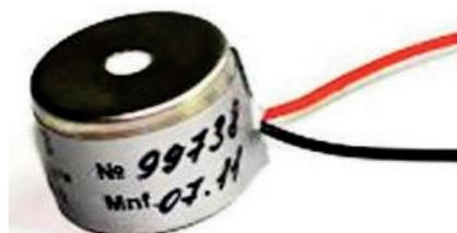
Рис. 1. Датчик кислорода Oksik 3
