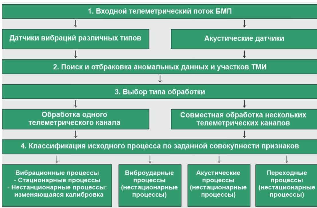
Рис. 1. Схема обработки БМП
