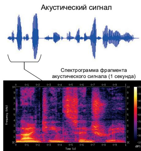
Рис. 1. Преобразование исходного акустического сигнала в спектрограмму
