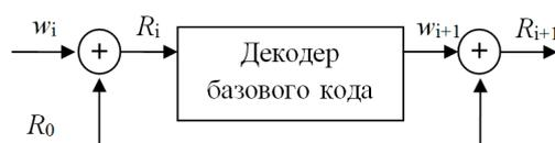
Рис. 1. Общая схема декодирования
