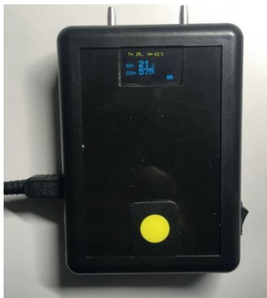
Рис. 2. Внешний вид комплексного устройства для оценки содержания кислорода и углекислого газа в воздушной среде
