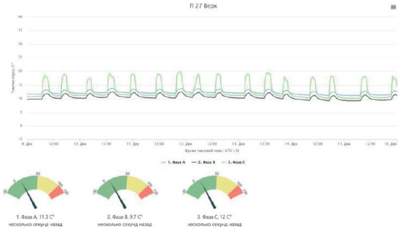
Рис. 8. Программный интерфейс комплекса контроля состояния электроэнергетического оборудования
