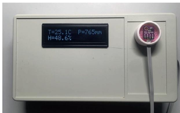
Рис. 2. Устройство для оценки относительной влажности кожного покрова
