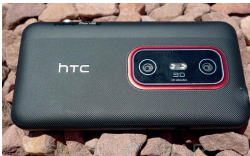
Рис. 2. Две задних камеры смартфона HTC Evo 3D
