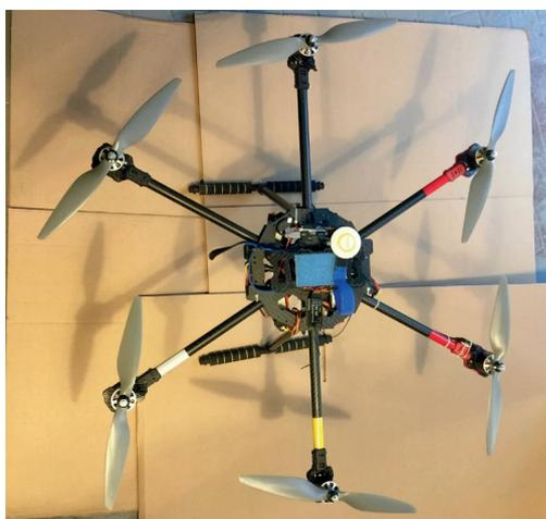
Рис. 3. Шестимоторный БПЛА вертолетного типа
