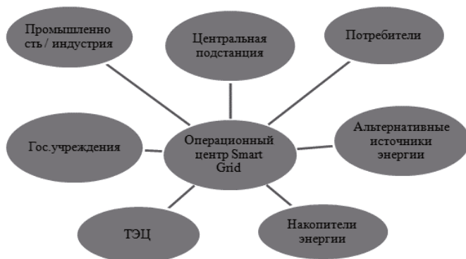
Рис. 2. Архитектура Smart Grid
