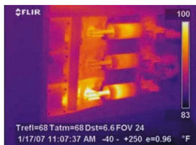
Рис. 4. Тепловое изображение ослабленного соединения
