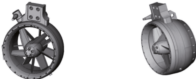
Рис. 1. ГЭД кольцевого типа, совмещенный с ВФШ
