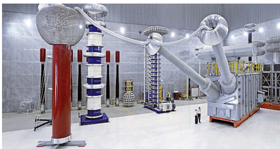
Рис. 2. Испытание трансформатора постоянного тока на сеть напряжением 1100 кВ
