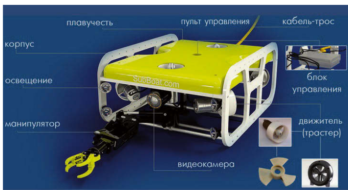
Рис. 2. Конструктивная схема подводного мини аппарата (фото взято с сайта http://subboat.com/ )
