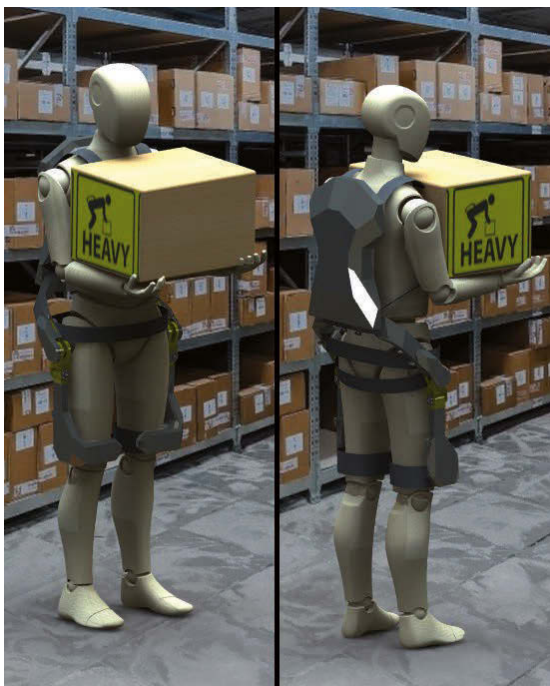
Рис. 1. Модель промышленного экзоскелета
