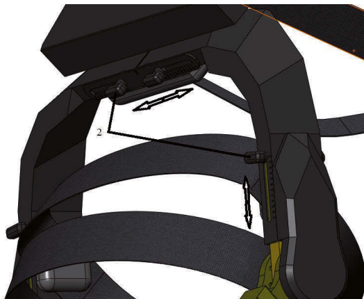
Рис. 2 б. Регулировка ширины экзоскелета и глубины посадки человека в экзоскелет: 1 – шкала-линейка; 2 – рукояти поджимных винтов
