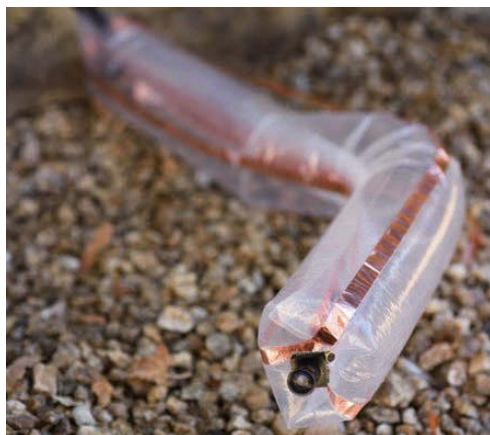
Рис. 3. Змеевидный робот Стэнфордского университета
