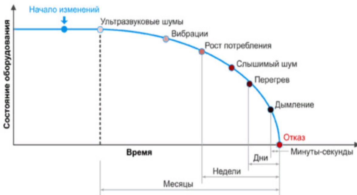
Рис. 1. Износ оборудования сопровождается различными косвенными признаками
