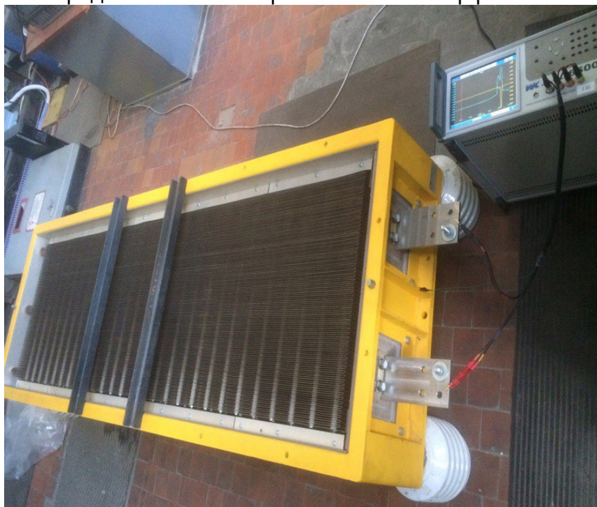
Рис. 7. Испытательное оборудование-секция резистора SNR, прибор Wayne Kerr
