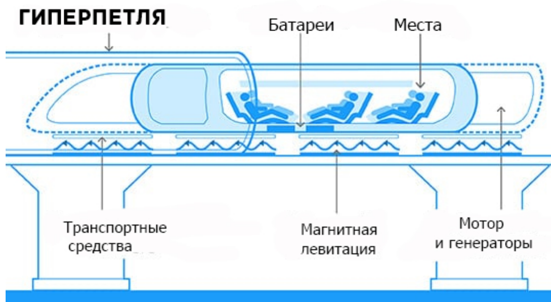
Рис. 3. Схема капсулы Hyperloop
