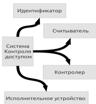
Рис. 1. Элементы системы контроля доступом
