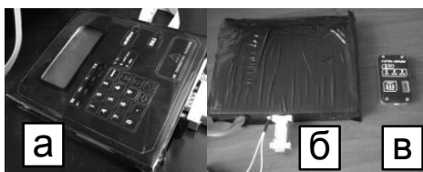
Рис. 5. Модули управления КПА-5А: а – первая версия (atmega16); б – вторая версия (crumb128, atmega128); в – текущая версия (STM32F1)
