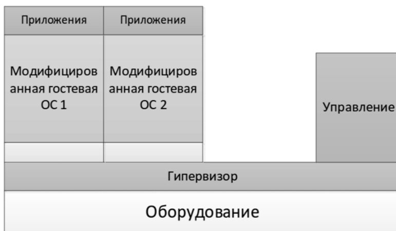
Рис. 2. Визуализация принципа действия паравиртуализации
