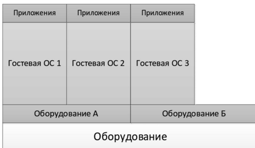
Рис. 1. Визуализация принципа действия виртуализации
