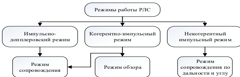
Рис. 4. Режимы работы РЛС при анализе радиальной скорости
