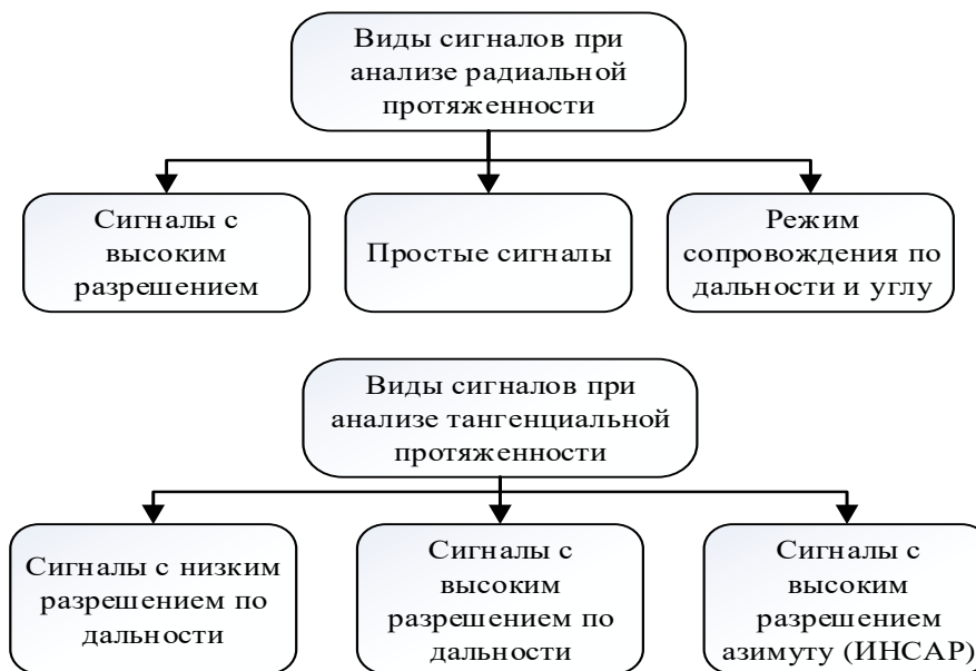
Рис. 5. Виды сигналов при анализе радиальной и тангенциальной протяженности
