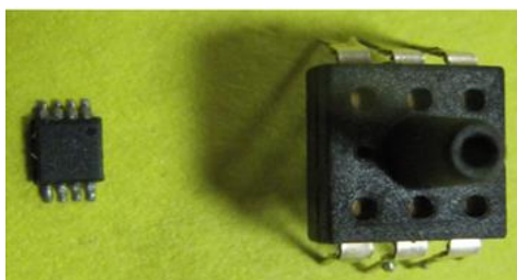
Рис. 7. Датчик давления и инструментальный усилитель
