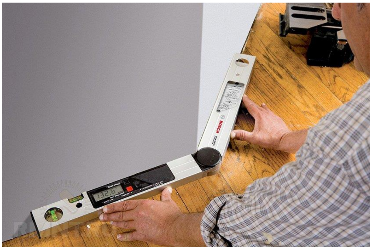
Рис. 3. Проведение измерений с помощью угломера [3]
