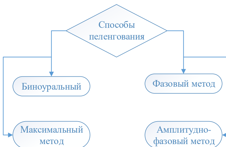
Рис. 4. Схема способов пеленгования в гидроакустике
