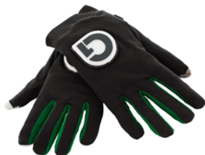
Рис.3 – Контроллер Gloveone в виде перчаток виртуальной реальности. Такая перчатка оснащена 10 вибромодулями (для обратной связи) и шестью гироскопами, позволяющими максимально точно отслеживать движения. Подключение производится с помощью Bluetooth
