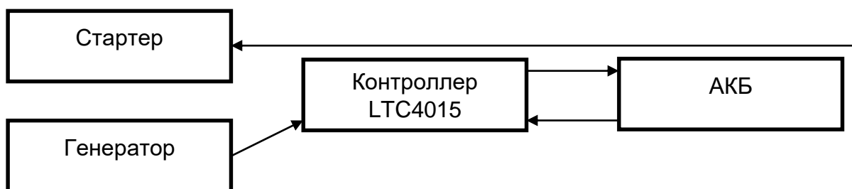
Рис. 3. Интеграция LTC4015 в общую схему подключения
