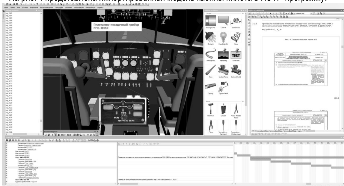
Рис. 4. Модель кабины пилотов Ан-26 в ИЭТР – программе
