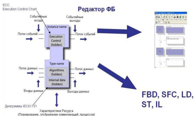
Рис. 3. Пример базового функционального блока МЭК 61499
