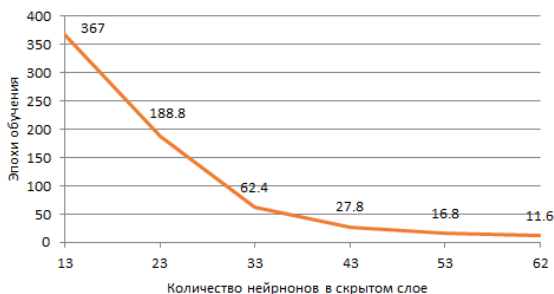
Рис. 1. Зависимость эпох обучения сети для заданной ошибки от количества нейронов в скрытом слое
