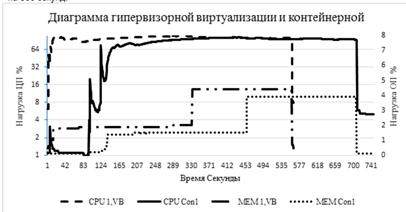
Рис. 1. Нагрузка процессора и оперативной памяти на одном контейнере/виртуальной машине
