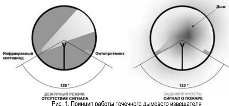
Рис. 1. Принцип работы точечного дымового извещателя
