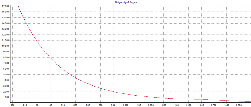
Рис. 2. Падение амплитуды зачки гироскопа от времени (при температуре +50 °С) Q = 190\,937 ед. , среднеквадратичное отклонение за 10 измерений = 976 ед.
