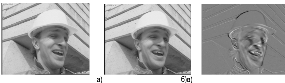
Рис. 1. Видеопоследовательность foreman а) 12-й кадр, б) 13-й кадр, в) межкадровая разность 12-го и 13-го кадров
