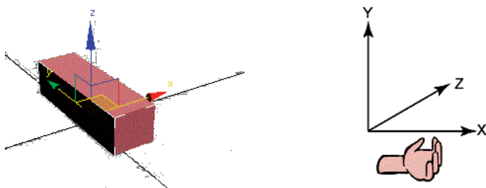
Рис. 1. Система координат слева 3Ds Max справа DirectX
