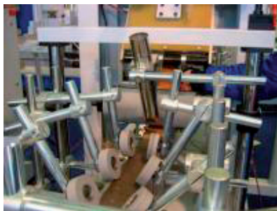
Рис. 1. Прижимные ролики на ламинационной машине
