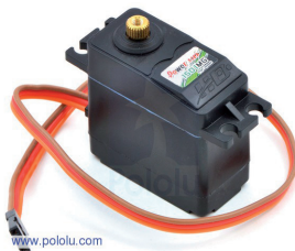
Рис. 2. Сервопривод с обратной связью
