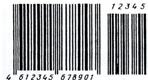
**Рисунок 8. Дополнительный к основному штриховой код**
