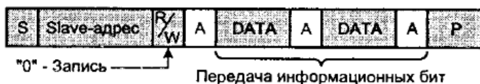
Рисунок 21. Передача данных от Master к Slave
