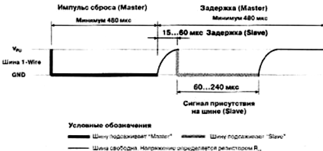
Рисунок 32. Временная диаграмма процесса начального сброса
