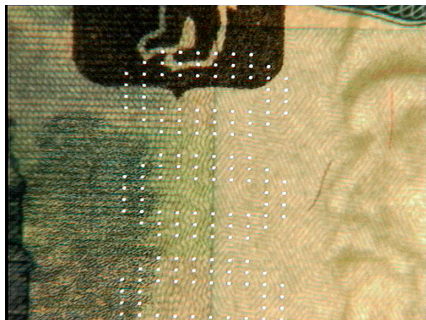
Рис. 1.10. Микроперфорации на бумажной основе денежных знаков РФ: а – изображение на просвет, б – изображение в отраженном свете
