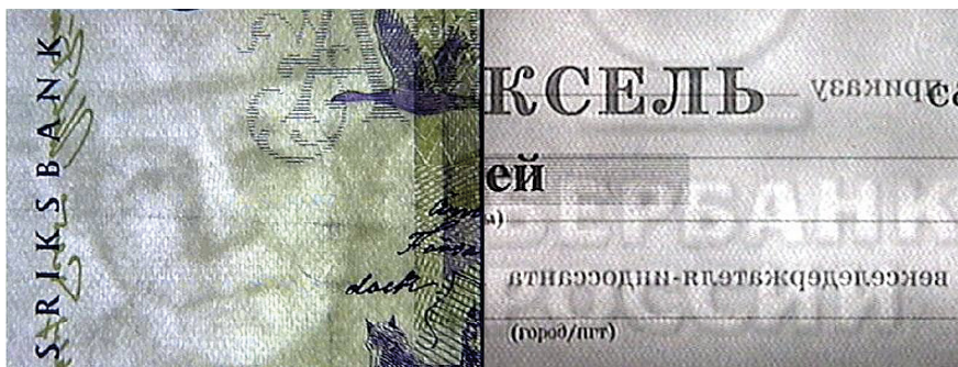
Рис. 1.2. Типовые примеры сетчатой структуры бумаги с ромбическим расположением маркировки от «сетки»
