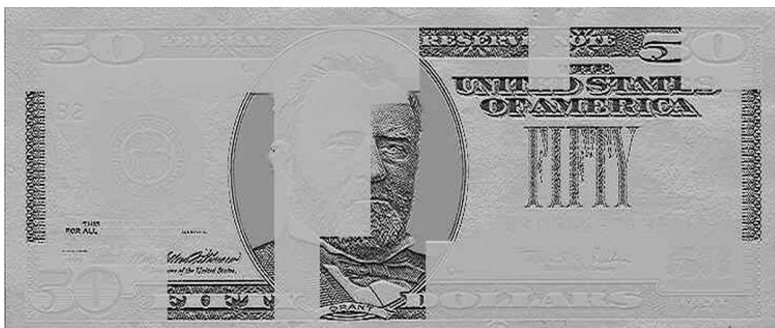
Рис. 2.4. Пример распределения ферромагнитной компоненты в составе краски на лицевой стороне банкноты 50 USD (1996 г.)
