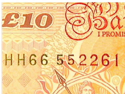
Рис. 3.2. Фрагменты, выполненные техникой высокой печати: а – печать казначейства на денежных знаках США; б – серийные номера банкнот Великобритании; в – серийные номера банкнот РФ с непропечатками
