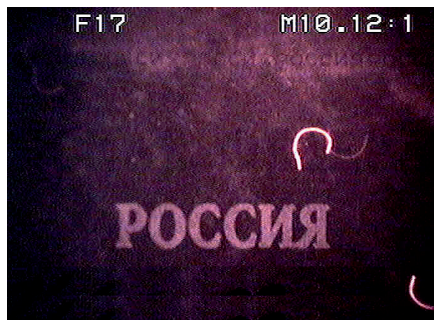
Рис. 2.10. Типовые примеры ИК-люминесценции красителей денежных знаков и документов: а – на лицевой стороне банкноты 5 EUR; б и в – красителей и защитных волокон на различных листах паспорта гражданина РФ
