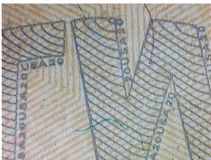
Рис. 4.5. Типовые примеры: а – выполнение негативного микротекста металлографией; б – выполнение микротекста офсетной печатью
