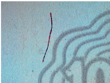
Рис. 1.1. Примеры защитных волокон в составе бумаги денежных знаков РФ: а – двуцветные с переменным сечением; б – люминесцирующие в УФ-излучении
