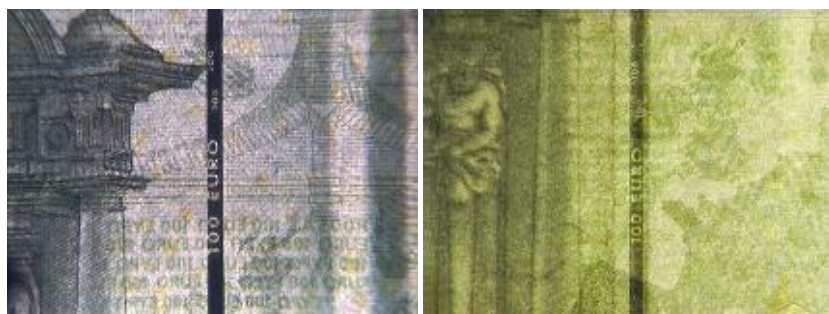
Рис. 6.3. 100 EUR. Справа – имитация встроенных защитных нитей надпечаткой красками
