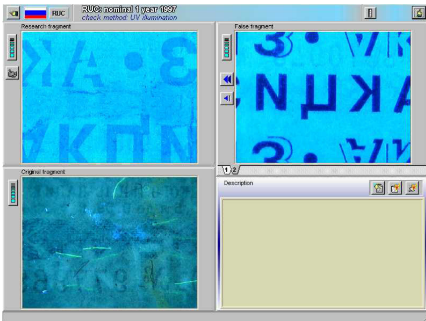
Рис. 6.5. Акцизные марки РФ. Вверху слева и справа – фрагменты имитации защитных признаков в УФ-излучении. Люминесцирующие волокна в бумаге подделок отсутствуют
