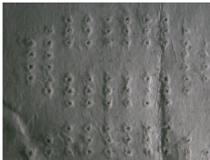
Рис. 6.7. Микроперфорации: а – отверстия, выполненные лазерным испарением; б – вид имитации механическими проколами бумаги в коспадающем освещении
