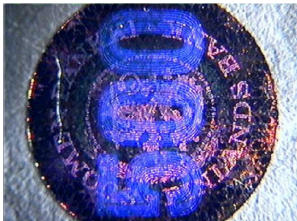
Рис. 1.9. Типовые варианты исполнения кинеграмм с голографическим эффектом на бумажной подложке банкнот: а – 500 FIM; б – 100 EUR
