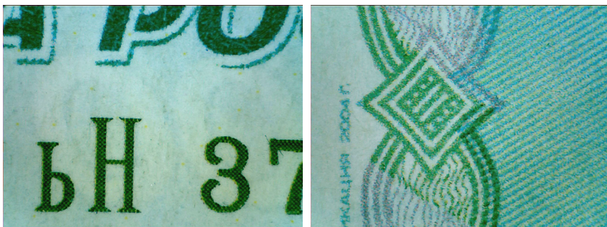
Рис. 6.11. Типовые примеры несанкционированного воспроизведения изображений денежных знаков (1000 RUR) с помощью бесконтактных способов печати (приведенные растриванные фрагменты образованы множеством точек, наблюдаемых при большом увеличении с потерей четких очертаний фигур)
