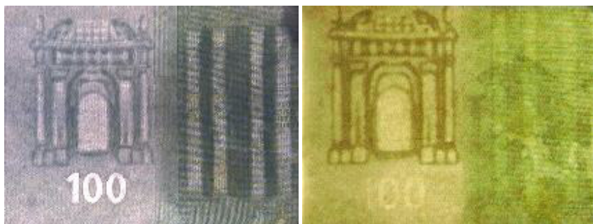
Рис. 6.2. 100 EUR. Справа – имитация водяных знаков увеличением и уменьшением оптической плотности с помощью надпечатки красками и пропитки маслами
