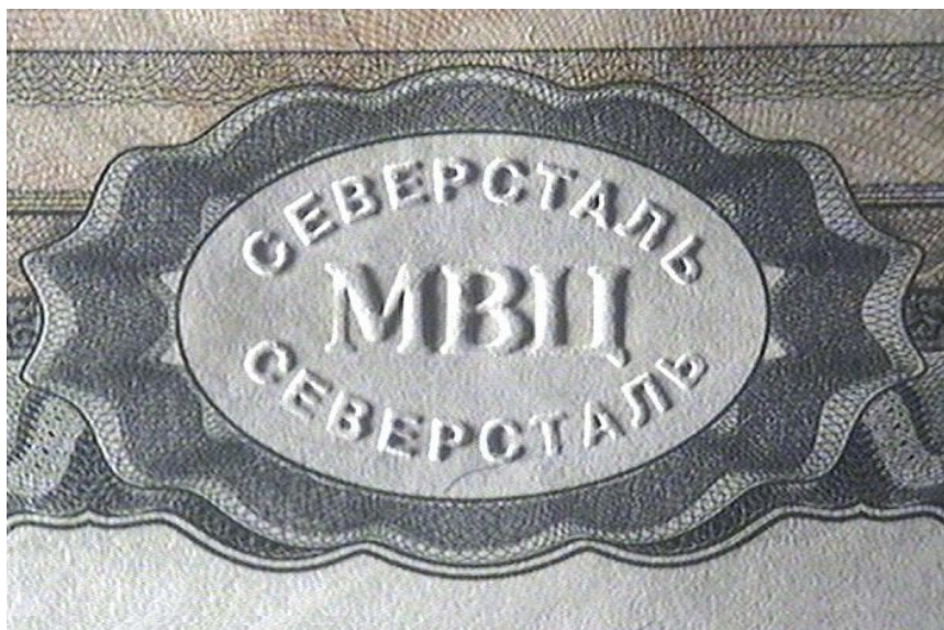
Рис. 4.11. Бескрасочное глубокое тиснение на ценной бумаге в косопadaющем свете
