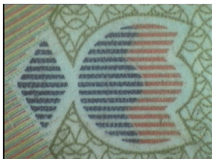
Рис. 3.8. Примеры орнаментальных узоров и фоновых сеток: а – на денежных знаках; б – на документах РФ, выполненных с использованием орловской печати
