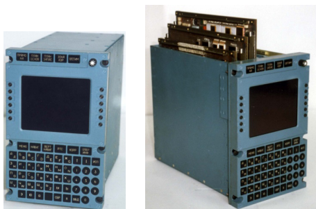
Рис. 29. Многофункциональный экранный пульт-вычислитель ПВ-95 (справа панели блока несколько выдвинуты)
