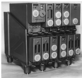
Рис. 13. Модификация БЦВМ Орбита-10 для самолета Су-24
