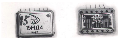
Рис. 10. Микросхема серии Трапеция-3 (сборка и со снятой крышкой)
