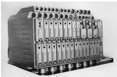
Рис. 9. Модификация БЦВМ Орбита-1 для НПК самолета Ту-144
