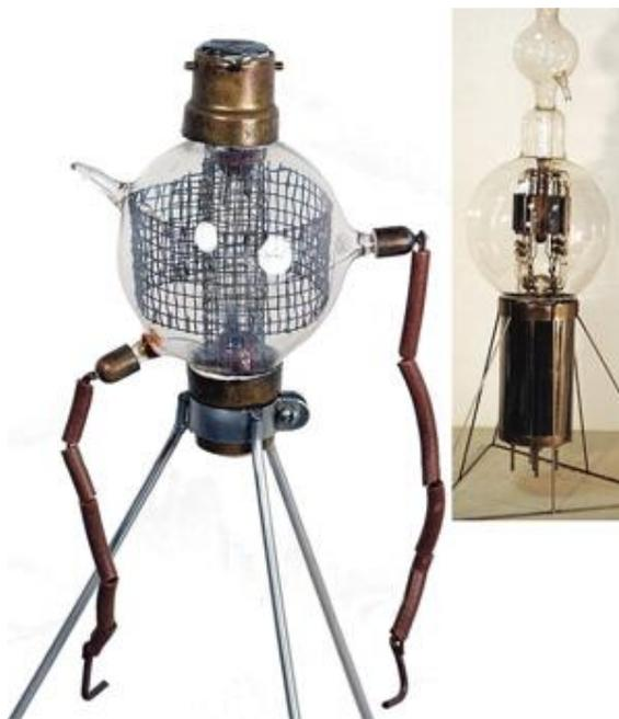
Рисунок 3. Экспериментальные конструкции мощных радиоламп.
