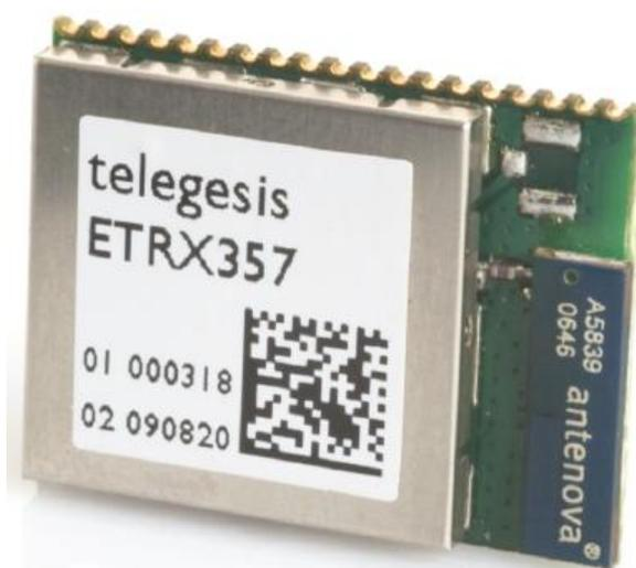
Рисунок 22. Модуль ETRX3
