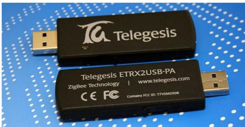
Рисунок 21. ZigBee модуль ETRX2USB
