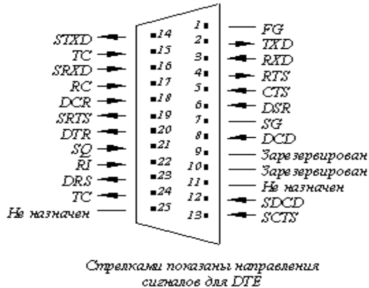
Рис.2.1. Назначение линий 25–контактного разъема типа D для интерфейса RS–232C
