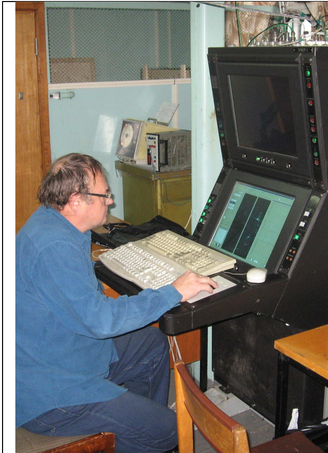
Ф70.Натурные испытания гидролокатора освещения ближней обстановки: тестирование алгоритмов автоматического обнаружения и сопровождения объектов
