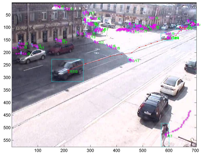
Ф71.Выделение и сопровождение подвижных объектов на изображении: автомобилей, пешеходов
