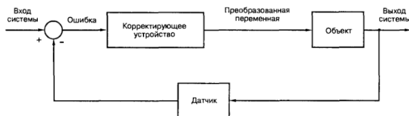
Рис. 8. Обобщенная схема регулирующего устройства
